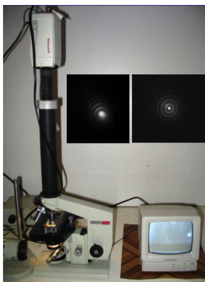
Рис. 8: Макет для юстировки микрообъективов (А. Воронин) 7)
