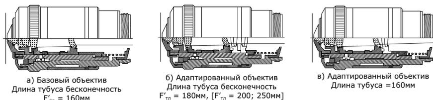
**Рис. 3** Адаптация унифицированной конструкции к различным параметрам тубуса
